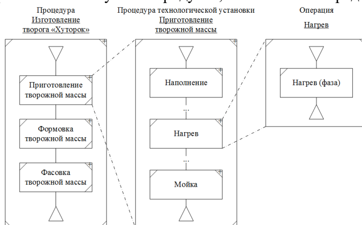
Рисунок 20 - Процедурная модель, выполненная в соответствии с ISA-88.00.02
